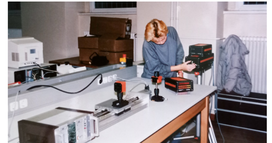
▲ CAQ – computergestützte Qualitätskontrolle und -sicherung; hier arbeitet 1988 Nachrichtentechnik-Studentin Astrid Sings an einem Aufbau zur optischen Vermessung von Schraubenköpfen. Foto: Andrae
